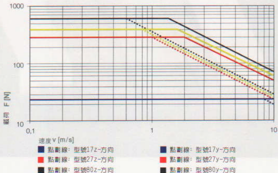
F=導軌上的總載荷 表28.1 FV-圖表, Drylin N 的最大允許動載荷
